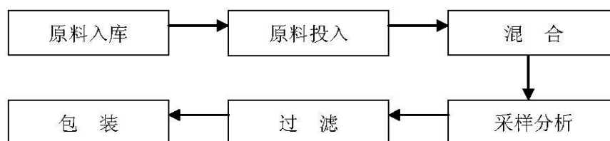
图1-6 显影液制造工艺流程简图
