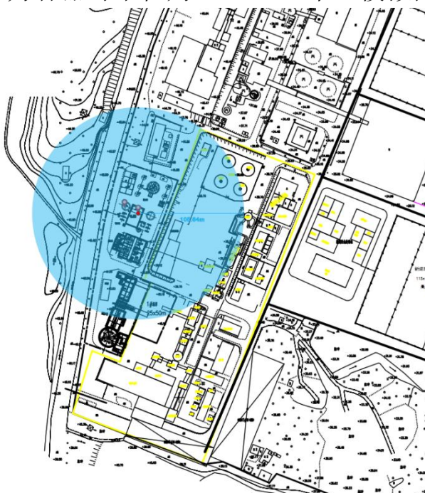
图 6-5 目标装置类型为压力容器时多米诺效应模拟图
